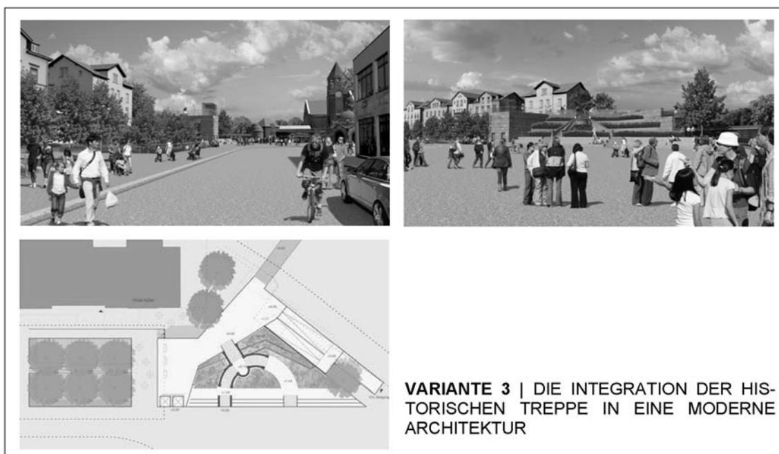
Die Treppe wird leicht versetzt, behält aber grundsätzlich ihre axiale Beziehung zum Bahnhofseingang. Das Hotel Adler bildet in dieser Variante die neue Platzkante. Das geplante Fahrradiefgeschoss erhält zu etwa 60% eine Öffnung als Verbindung zum eigentlichen Platzniveau.
