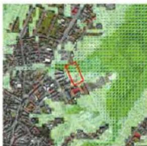
Das bodennahe Strömungsfeld (Pfeile) und der Kaltluftvolumenstrom (Farbe) heben die Bedeutung der Planfläche als Durchtrittsbereich für Kaltluftströmungen hervor.
